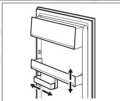
Чтобы обеспечить возможность хранения упаковок продуктов различных размеров, полки дверцы можно размещать на разной высоте. Для выполнения этой операции действуйте следующим образом: медленно потяните полку в направлении, указанном стрелками, пока она не освободится; затем установите ее на нужное место.
